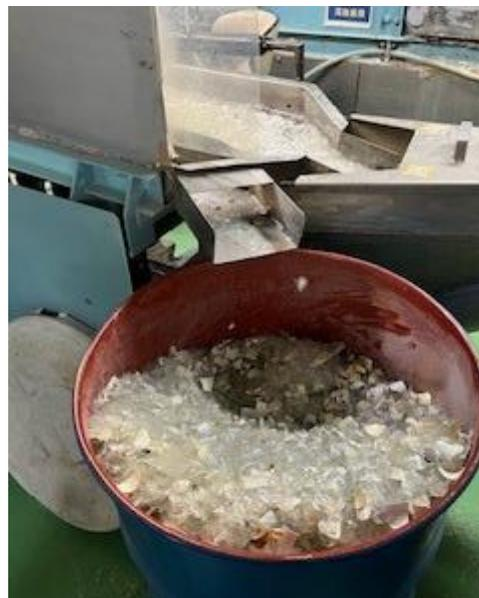
イトムカには様々なタイプと形状の乾電池、二次乾電池が入ってくるが、まずは乾電池を形状別で分ける。これはオリジナルの選別機を置いているが、最終的には手選別。経験がものをいう。乾電池、蛍光灯以外では水銀を用いた体温計、血圧計もたまに入ってくるという。
